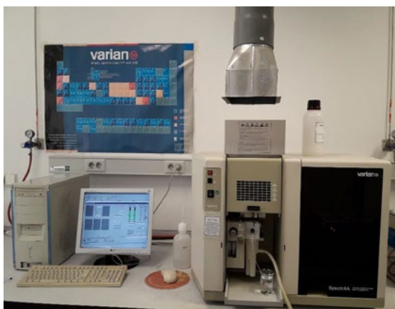
Figura 16. Espectrofotómetro de absorción atómica Varian Spectra 220.
