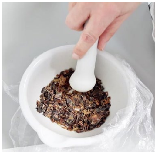
Figura 10. Pulverizado de las muestras secas en mortero.
